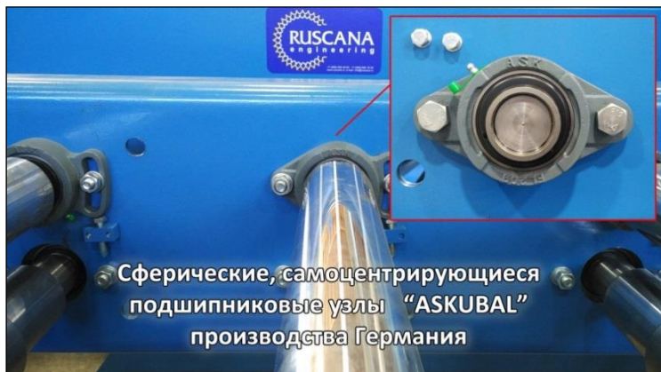
Консольный разматыватель обеспечивает быструю смену рулонов
