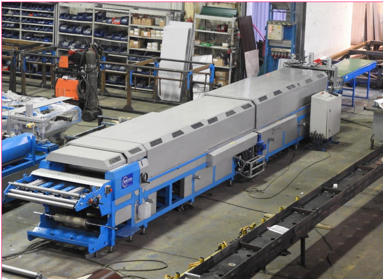
Рис. 7. Прокатный стан со стороны заходного блока
