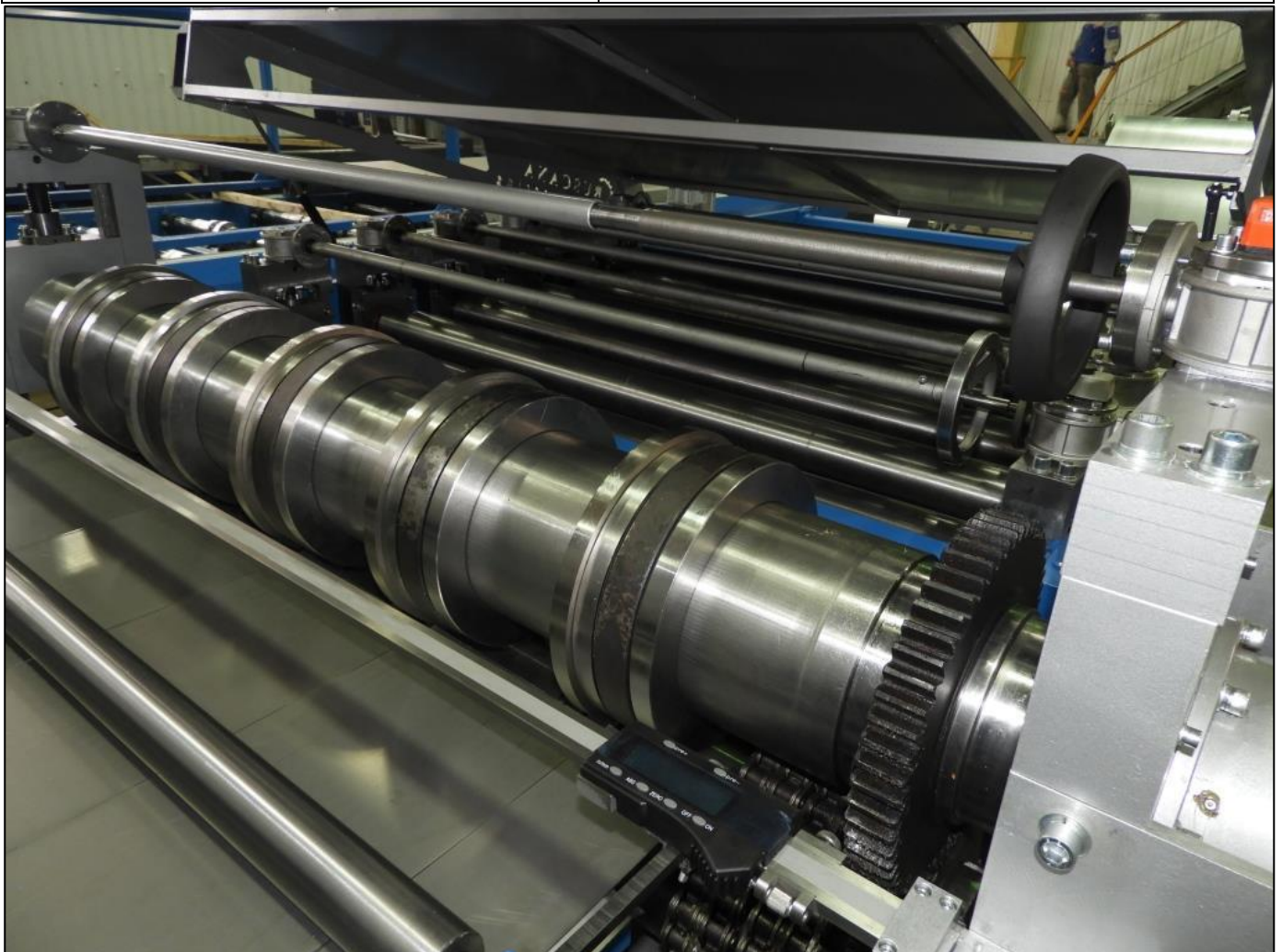
Рис. 9. Пример набора дисковых ножей на планшайбе в модуле продольного роспуска.
