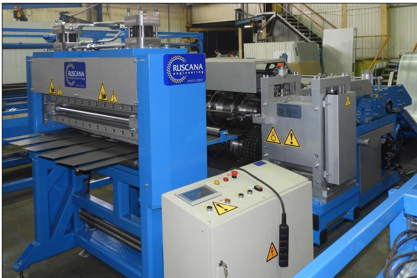
Рис. 6. Общий вид машины продольно-поперечного роспуска металла.
