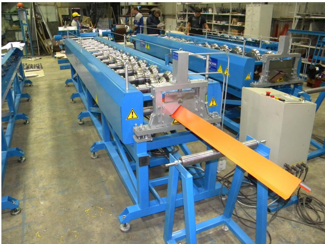
Линия для производства профилей «Планка торцевая» двух типоразмеров, именуемая далее по тексту «Оборудование», предназначена для изготовления профилей планки торцевой двух типоразмеров. Профиль используется при монтаже кровли в качестве доборного элемента. Чертеж профилей представлен на рис. 1 (см. на стр. 3).
