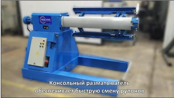
Консольный разматыватель обеспечивает быструю смену рулонов
